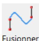
Le bouton fusionner apparaît lorsque on a sélectionné le premier point ou le dernier point d'un alignement qui est commun avec le premier ou le dernier point d'un alignement de même type. L'appui sur ce bouton permet de fusionner les deux alignements.
