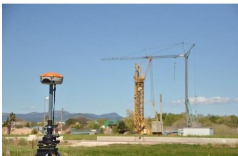
Topocalc gère le fonctionnement des GPS Geo-FENNEL FGS1 soit en réseau soit en base/mobile.
